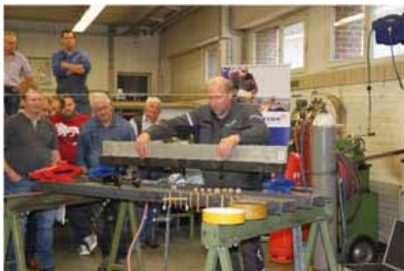
Abb. 1: Vorführung der Ausricht-Technologie „Flammrichten“
